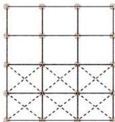
Wire can be added diagonally for additional surface. Puede añadirse alambre en diagonal para superficie de amarre adicional.
